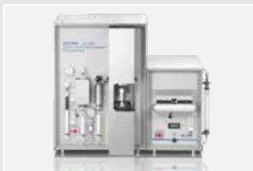
CS-2000 – уникальный анализатор, который позволяет определять содержание углерода и серы и для органических, и для неорганических проб. Это возможно благодаря технологии ELTRA Dual Furnace (EDF), которая означает применение двух печей в одном приборе.
