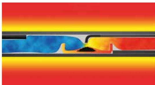
Горизонтальная печь сопротивления анализаторов CS-580 | CHS-580 имеет керамическую трубку сгорания и нагревательные элементы из карбида кремния. Полный электронный контроль позволяет увеличить время между обслуживанием благодаря ограничению тока во время прогрева печи. Специальный датчик контролирует температуру окружающей среды и передает данные системе автоматической компенсации контроля температуры, обеспечивая независимость температуры печи от температуры окружающей среды.
